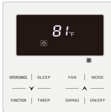
Fig. 6.4 Interface of Off status in Fahrenheit
